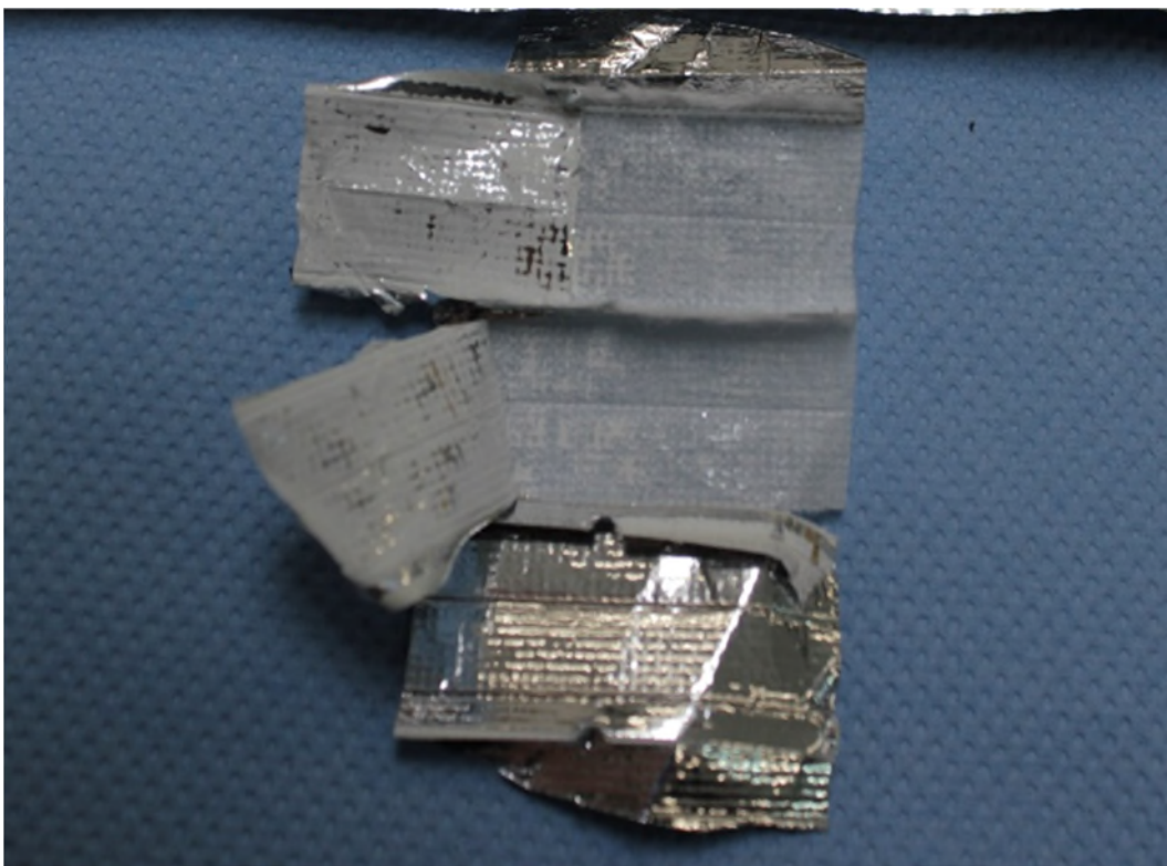
Abbildung 4 Auch das Plissee in der Nähe des verfärbten PVC hat sich verändert: Die metallische Beschichtung lässt sich leicht vom Textil trennen, der Bruch/Abriss erfolgt in der Klebefuge.
